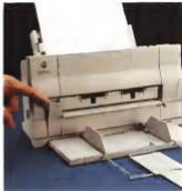
Per accedere alle cartucce di inchiostro è sufficiente sollevare il pannello superiore nell'angolo in alto a sinistra e tirare per il filo delle braccia. È possibile installare manualmente i fogli ed estrarre fogli incompiuti nel meccanismo.
