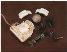
▼ Vista dall'interno. Si notano le componenti elettroniche integrate ed il chip ASIC Motorola.
