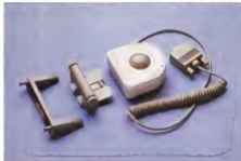
Esplorò del dispositivo in cui si notano i due pezzi del morsetto ed il corpo del trackball.
