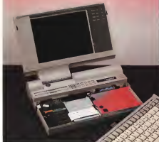
Vista generale del computer con la tastiera estratta dalla sua sede. Notare al centro il rinvolto ventolatore.
