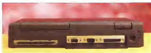
Da sinistra il connettore per la docking station, l'uscita video, la porta seriale e quella parallela
