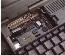
Planchette della slot custom per l'innalzamento della velocità operativa. Si noti il Dissip. specifico per il 486SLC
