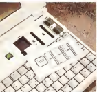
L'allargamento per l'espansione di memoria e il coprocessore matriciale
