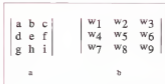
Figura 1 - Schema di moltiplicazione a blocchi. In a sono rappresentati i pixel, in b le moltiplicazioni.
