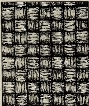
Fig. 25. Rechte, dichte éénslag.
