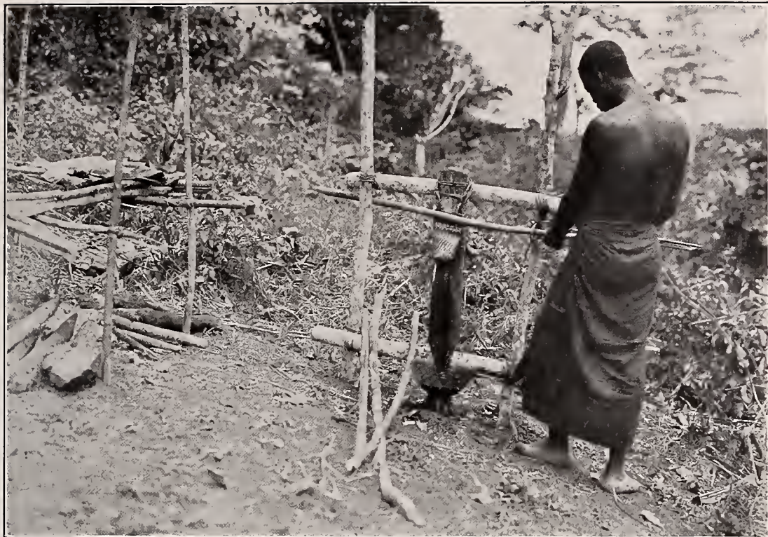
Abb. 144. Ölpreſſe, auf der Raphiapalmöl ausgepreßt wird. Links wird das ölhaltige Fruchtſſeiſch über Feuer erhitzt.
