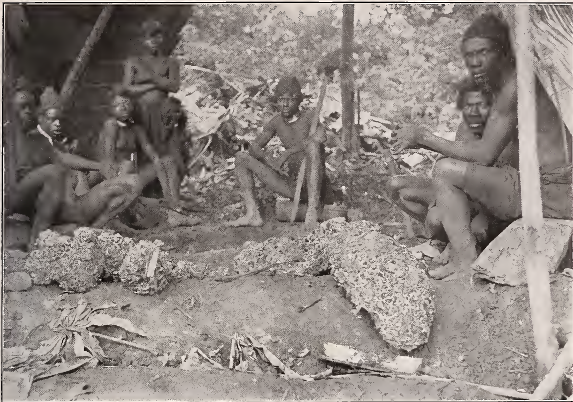
Abb. 185. Gewonnenes Eisen (Luppe) nach Abbruch des Schmelzofens. Bébaí (Fam. Schumu).
