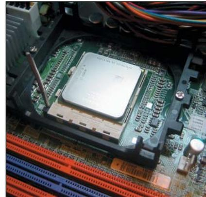
*Così si presenta una delle due sedi per CPU Opteron nel server Acer Altos G5350: il dissipatore attivo, che si fissa senza viti grazie a due semplici clip, è stato momentaneamente rimosso. La levetta, qui in posizione verticale, serve per azionare lo sblocco dello zoccolo ZIF (Zero Insertion Force). Ogni CPU è associata a 4 banchi DIMM (rossi e blu nella foto) per moduli RAM ECC*
