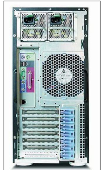
**Il G5350 può montare un alimentatore singolo o doppio, con ventole e connessioni totalmente indipendenti (in alto nella figura).** Subito sotto gli alimentatori, si noti anche la ventola di raffreddamento generale, di generose dimensioni, e il buon numero di slot PCI con dispositivo di sblocco facilitato
