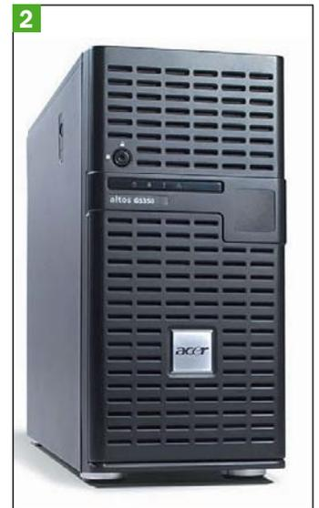
**2 - L'Acer Altos G5350** è un moderno server a 64 bit in architettura multiprocessore. Supporta uno o due chip Opteron single o dual core, per un totale massimo di 4 CPU. Ogni singolo core di questa macchina ha una potenza di calcolo diverse migliaia di volte maggiore di quella del MicroVax II. Gli otto slot DIMM possono ospitare complessivamente 16 GB di RAM ECC mentre la sezione dischi può raggiungere i 640 GB per array
