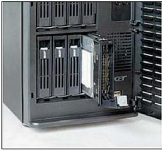
**Particolare della sezione dischi ad accesso frontale del G5350.** Ogni cestello può ospitare fino a 4 unità hot-pluggable, Ultra320 SCSI. Il controller supporta schemi RAID per le prestazioni (0) o per la sicurezza (1)
