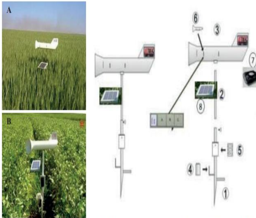
Figura 1. Coletor de esporos SIGA em lavoura de trigo (A) e soja (B). Desenho esquemático: 1 - Base do coletor; 2 - Haste de sustentação; 3 - Tubo do coletor de esporos; 4 - Bateria de 12 V; 5 - Termo-higrômetro; 6 - Suporte de lâminas; 7 - Cooler de sucção do ar; 8 - Placa solar.
