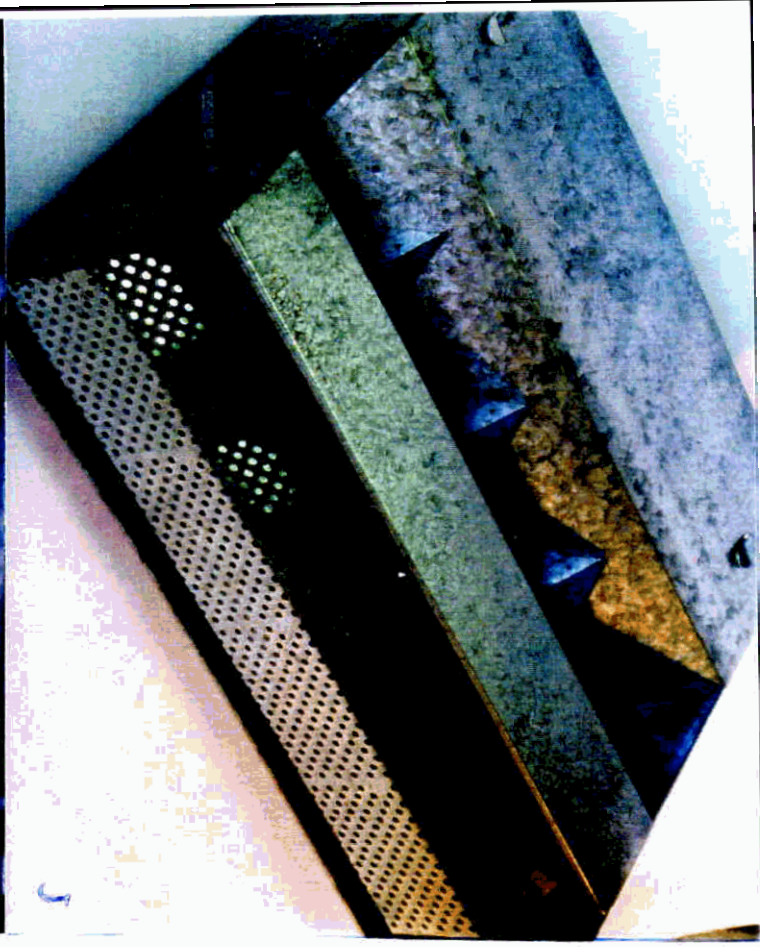
J- Soldadura, poca protección contra orines
