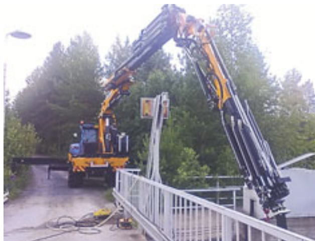
Traktorialustainen nosturi alaspäin taittuvalla puomilla on kätevä monissa töissä. Kuvassa huolletaan tulvaportteja. (Kuvat Seppo Moilanen)
