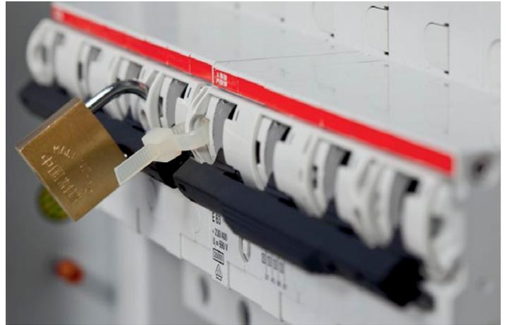
40 mm (12 mm x 5/10 mm) vorgesehen. Die Baureihe S750DR ist zur Montage auf einer 35 mm Hutprofilschiene nach DIN EN 60715 vorgesehen. Geräte der S750-Familie beinhalten eine integrierte Sperrmöglichkeit, die eine gleichzeitige Blockierung der 3 Pole einer Drehstrom-Versorgung ermöglicht. Der integrierte Sperrschieber verriegelt in EIN- oder AUS-Stellung und kann zusätzlich mit Vorhängeschloss, Drahtplombe oder Kabelbinder gesichert werden.
