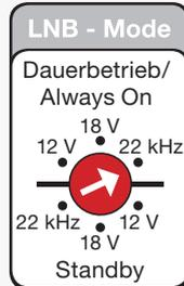
LNB-Speisespannungswahlschalter für Quattro und QUAD-LNB
