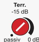
Dieser Regler ermöglicht die Absenkung des terr. Signals bzw. die Erweiterung des Rückwegs
