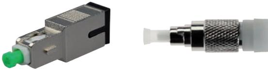
Zum Einpegeln von optischen Übertragungsstrecken werden oftmals Dämpfungsglieder (Festwertabschwächer) verwendet. Diese sollen in optischen Netzen verhindern, dass auf sensitive Receiverdioden zu viel Licht trifft und diesen schadet. Dämpfungsglied männlich-weiblich (Kupplung-Stecker)
