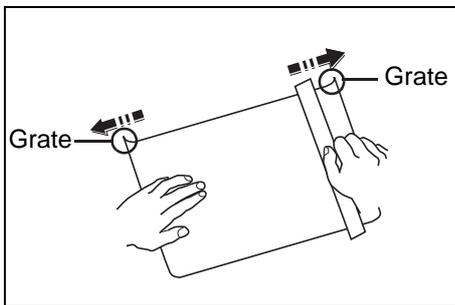
Dickes Papier vor dem Einlegen auffächern und sorgfältig an der Kante ausrichten. Einige Papiersorten haben an einer Seite eine raue Kante, die durch den Schneidevorgang entsteht. Solche Papiere auf eine flache Unterlage legen und die Kanten mit einem Gegenstand (z. B. einem Lineal) glatt streichen. Ansonsten kann es zu Staus kommen.
