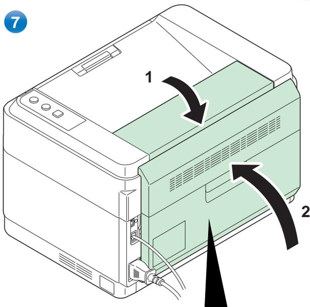
Schließen Sie die hintere Abdeckung, um den Fehler zu löschen. Der Drucker heizt auf und setzt den Druckvorgang fort.
