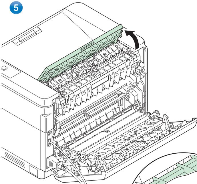
**VORSICHT** Die Heizung im Inneren des Druckers ist heiß! Nicht berühren - Verbrennungsgefahr!
