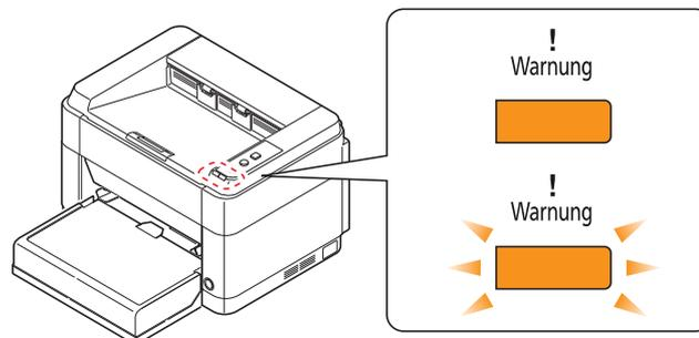
**Hinweis** Falls die Anzeigen in einer Weise leuchten oder blinken, die nicht weiter oben beschrieben wurde, liegt wahrscheinlich ein Fehler vor, der einen Serviceeinsatz erforderlich macht. Schalten Sie den Hauptschalter aus, ziehen Sie das Stromkabel. Warten Sie einen Augenblick, stecken Sie das Stromkabel wieder ein und schalten das Gerät mit dem Hauptschalter ein. Eventuell ist der Fehler nun behoben. Tritt der Fehler dann immer noch auf, verständigen Sie den Kundendienst.
