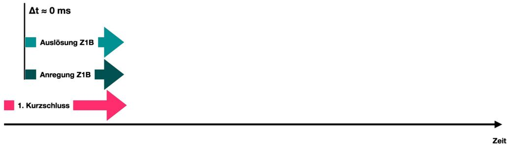
Der Leistungsschalter wird ausgeschaltet und es beginnt der Ablauf einer zuvor projektierten Totzeit von 500 ms.
