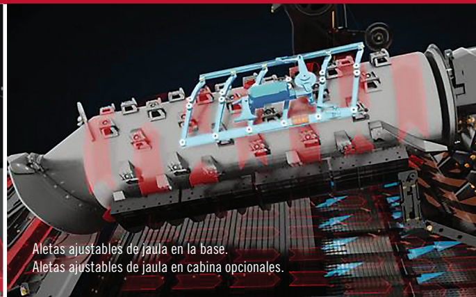
Las aletas ajustables de jaula le brindan al operador la capacidad de optimizar el proceso de trilla y separación.
