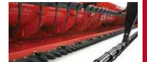
Cabezal de grano: sin fin de mayor diámetro, con Dedos retráctiles en toda la longitud
