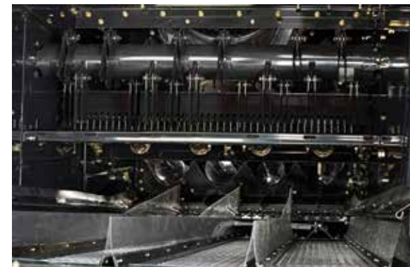
Cribas y mesa de sinfines con secciones alineadas
