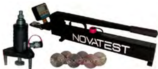
Ryc. 5.12. Przykładowy zestaw do badania metodą pull-off – firma Merazet [207]
