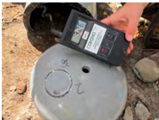
Ryc. 6.34. Badanie wytrzymałości na odrywanie powłoki polimocznikowej od powierzchni PCV
