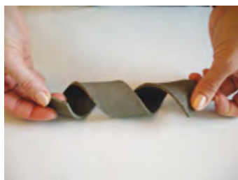
Ryc. 3.2. Wizualizacja cech giętkości paska z powłoki polimocznikowej
