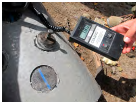
Ryc. 6.35. Badanie wytrzymałości na odrywanie powłoki polimocznikowej od powierzchni PEHD
