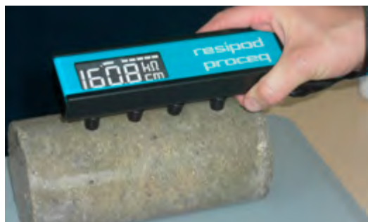
Ryc. 6.74. Badanie postępu korozji chlorkowej w betonie metodą NDT
