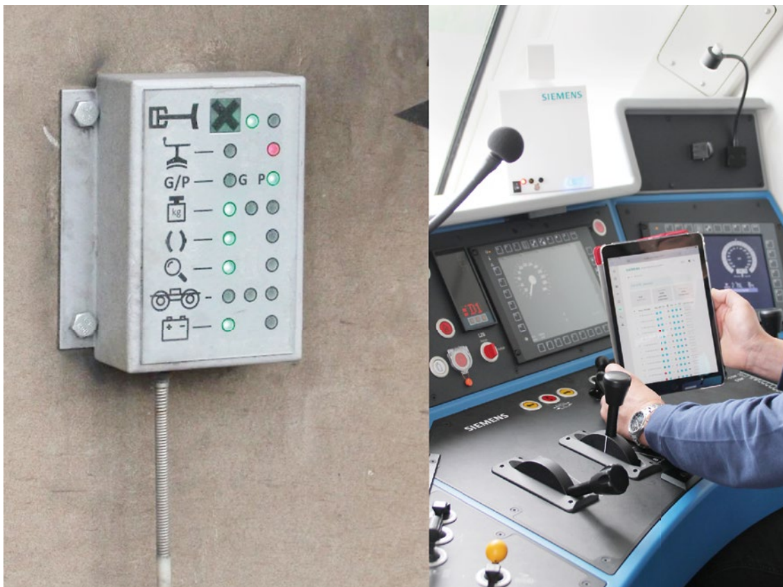
Bild 2: Elemente eines automatisierten Bremsprobensystems: (links) Display für Zustandsdaten für einen Waggon und (rechts) Empfängerbox mit angeschlossenem Tablet und Applikation zur Durchführung automatisierter Bremsproben und zur Anzeige von Zustandsdaten für jeden Waggon eines Zuges
