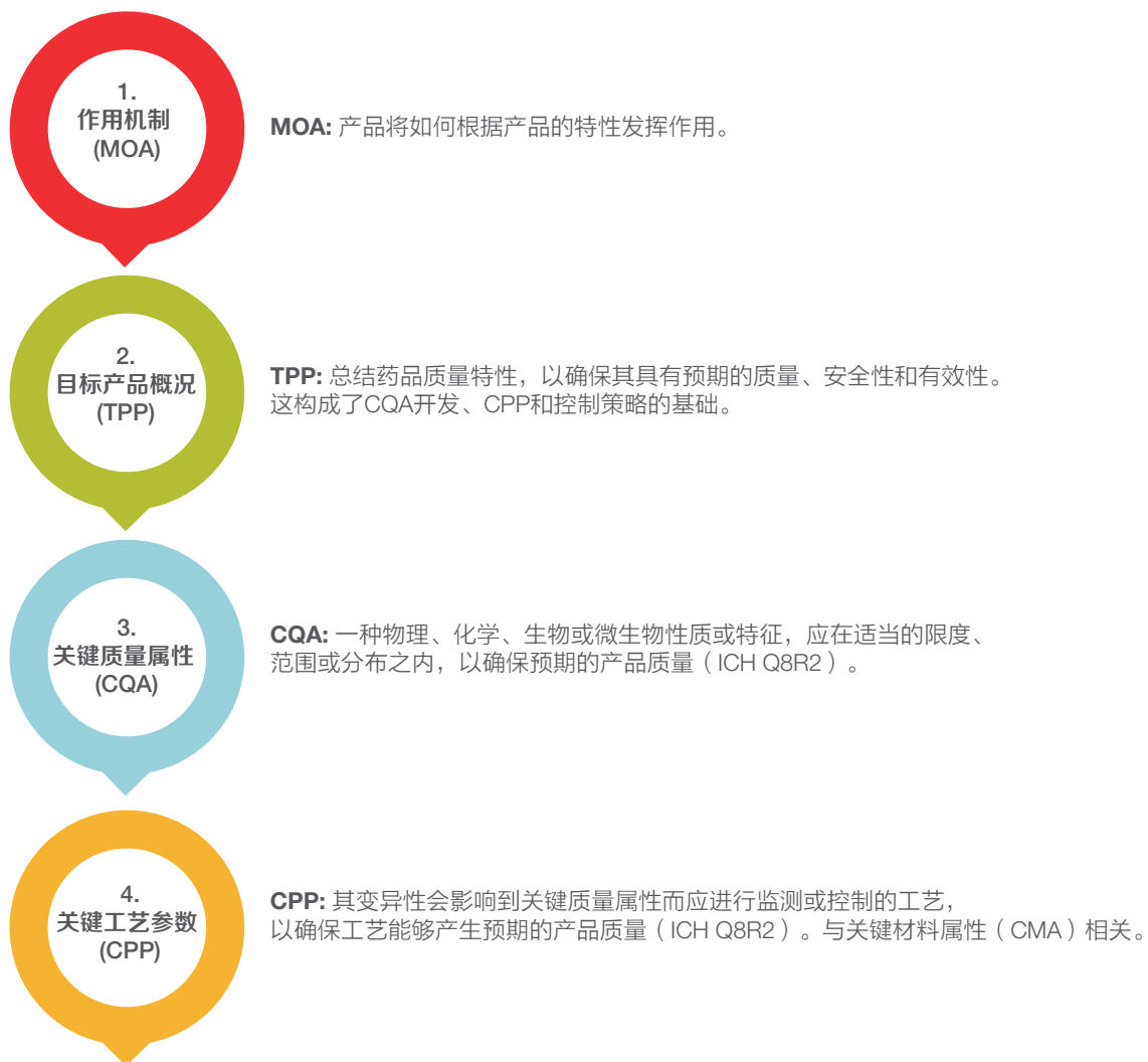
图1.质量源于设计 (QbD) 原则。该通用方案提供了一个决策框架, 细胞治疗产品开发者必须制定该框架以定义和控制细胞治疗产品的质量。基于FDA的Finn博士提出的方案 6 。
