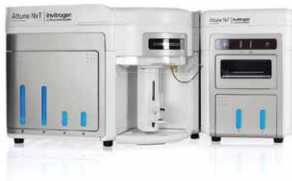
Attune NxT流式细胞仪采用一种创新性的体积进样和液流输送系统。样品可通过注射泵加样至Attune NxT流式细胞仪中，从而准确测量获取的样品体积，进而准确计算细胞浓度。由于具有省时、高通量且分析稳定的特点，高通量流式细胞仪有望成为一种高效而实用的系统生物学研究手段。这些近期的研发成果扩展了流式细胞仪在药物发现以及生命科学研究领域中的应用，并成为了解细胞和分子科学网络的一个关键手段。
