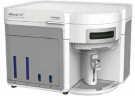
本文展示了如何使用Invitrogen™ Attune™ NxT流式细胞仪检测模式生物海分枝杆菌 (*Mycobacterium marinum*) 中的中性脂。这款流式细胞仪可避免仪器堵塞或细胞浪费, 实现温和且安全的细胞分析, 因而适用于各种不同的细胞类型鉴定。Attune NxT流式细胞仪采用声波辅助的流体动力学聚焦技术, 其先进的流体学设计可最大限度防止仪器堵塞, 高效处理多种类型的细胞, 因此Attune NxT可以快速、准确、高通量地处理多种类型的样品 (包括大量成团细胞和低浓度细胞样品)。在本应用指南中, 我们利用亲脂性Invitrogen™ BODIPY™ 493/503染料对中性脂进行染色, 并采用488 nm激发光以及530/30 nm滤光片 (BL1检测器) 进行检测。
