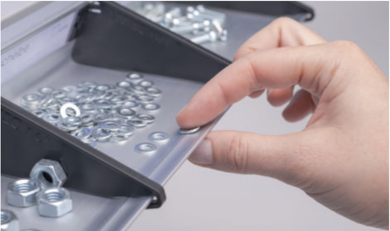
Kleinteilebereitstellung, Entnahme mit Vereinzelung über Abstreifgriff
