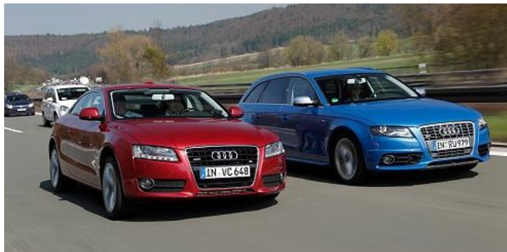
Abbildung 3.2: Querkraftfreies Fahren. Der aktiv eingebrachte Wankwinkel (linkes Fahrzeug) unterscheidet sich deutlich vom Wankwinkel des passiven Fahrwerks (rechts). Bild aus [142]
