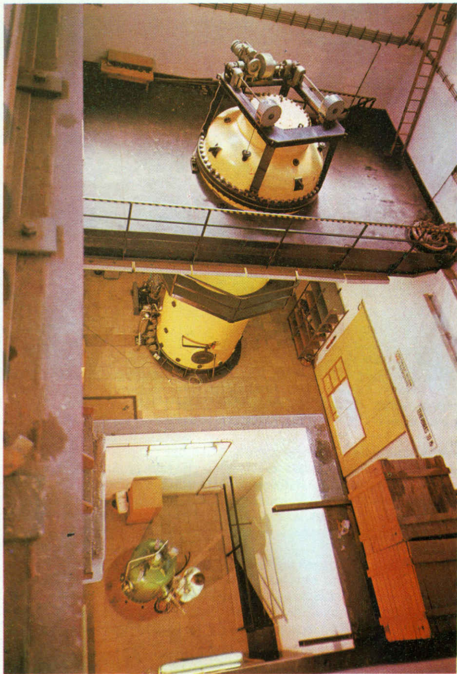
Az ötmillió voltos és az egymillió voltos Van de Graaff gyorsító
