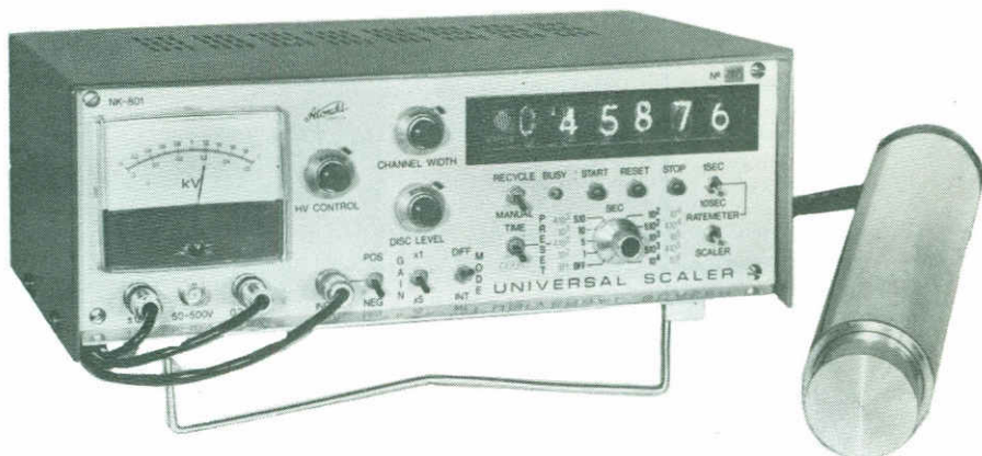
Egy ATOMKI-műszer: univerzális számláló radioaktivitás méréséhez
