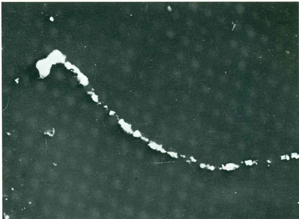
Béta-bomlás ködkamrában. Az elektron és a visszalökött mag nyoma látható. A neutrínó kilépésére az utal, hogy a nyomok nem 180°-os szöget zárnak be
