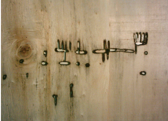
Figura 4: Lámina de madera de álamo con daño de taladrillo.
