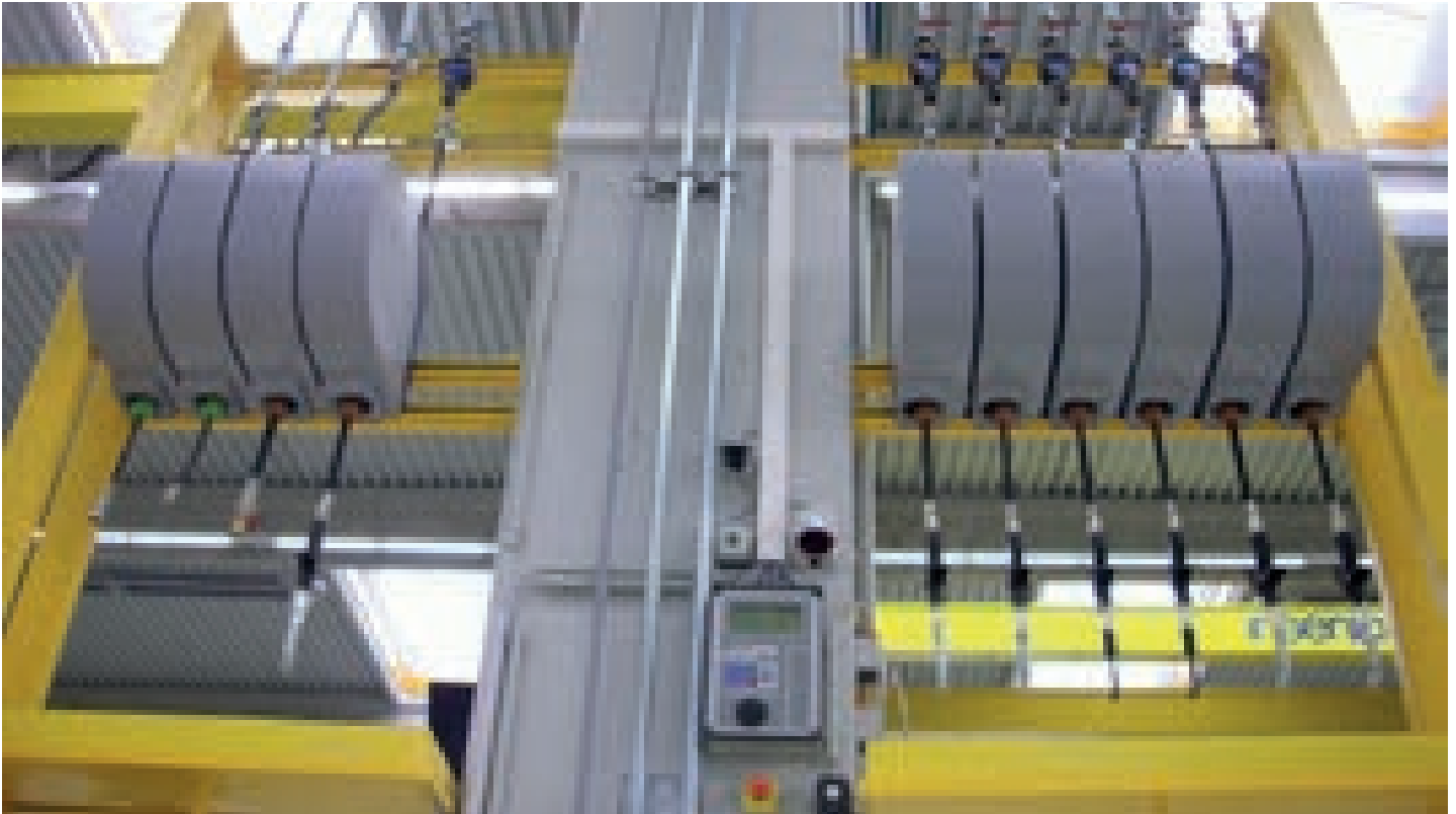
Schlauchaufroller auf einer Sonderkonstruktion - an Kundenbedürfnisse angepasst.
