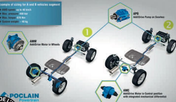
Poclair Powertrain pour son système de transmission intégrale hydraulique temporaire baptisé **AddiDrive™** et adaptable à tous types de véhicules.
