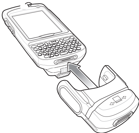
Abbildung 7-11 Montage des MSR-Moduls
