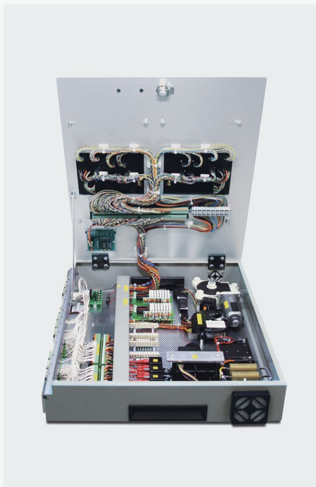
▲ Abb.: Testadapter (Teradyne) für Türsteuergeräte
