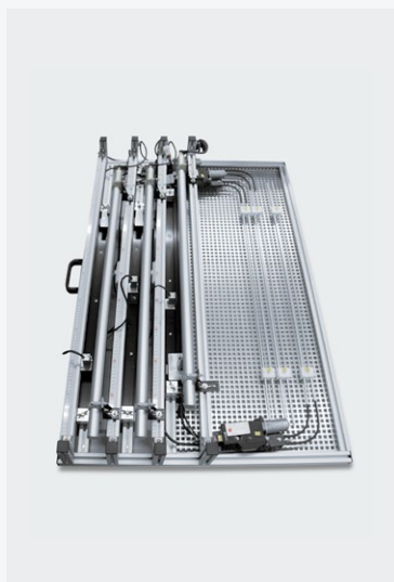
▲ Abb.: Simulationen an einem Schiebedach (Referenzierungs-Anschläge, Blockierung auf Normal-Verfahrweg)
