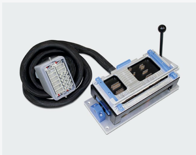
▲ Abb.: Nadelbettkontaktierung für Leiterplatten
