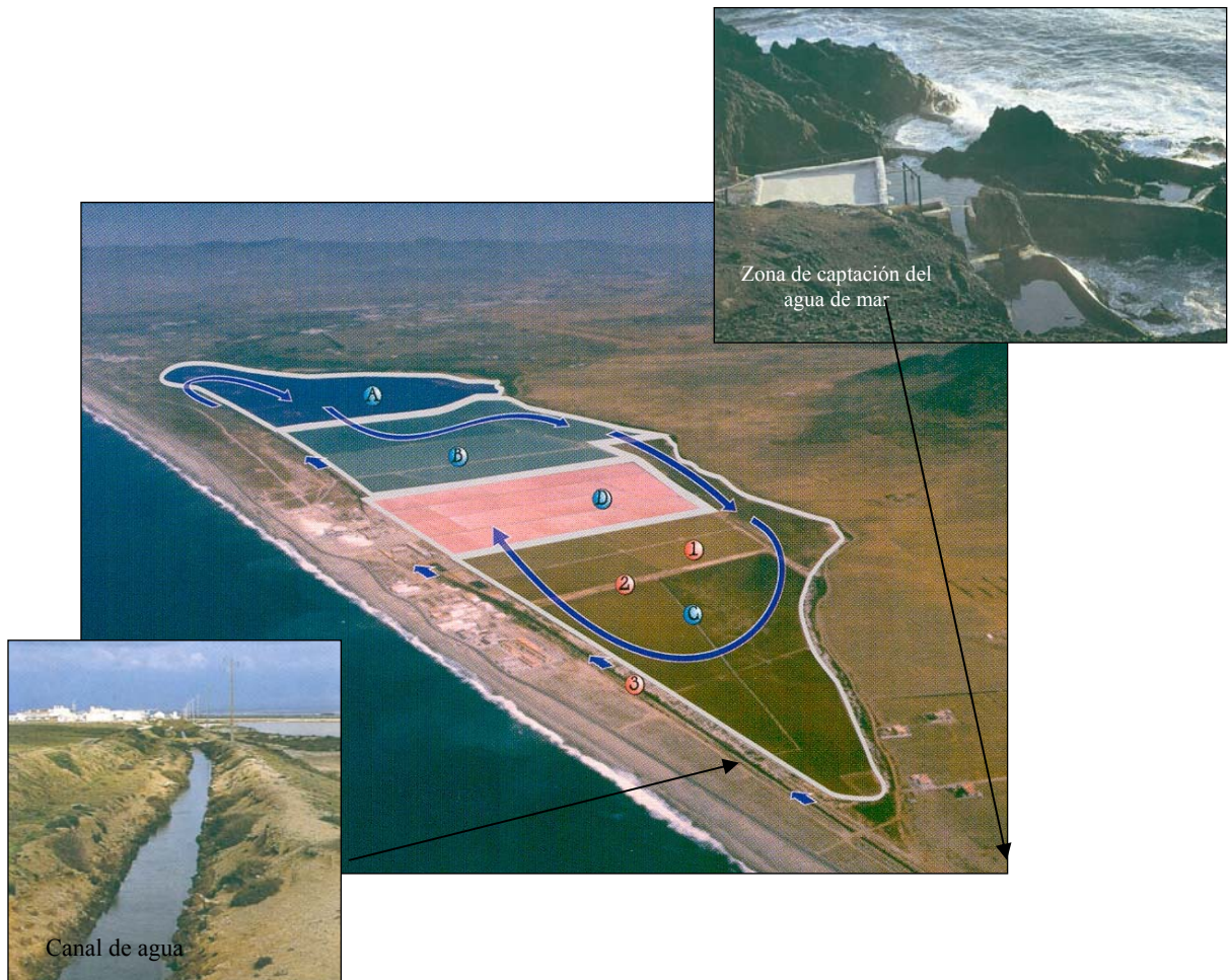
Circuito de agua del proceso salinero de las Salinas de Cabo de Gata. (Almería).
