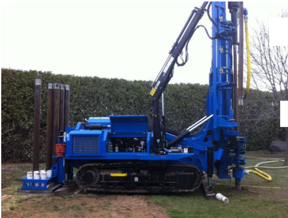
Slika 1.6 Bušaće postrojenje Geo-Max za izradu geotermalnih bušotina (Izvor: https://drillingsupply.info/geothermal-drilling-rigs/geothermal-drilling-track-rig-gm840-dd.html )
