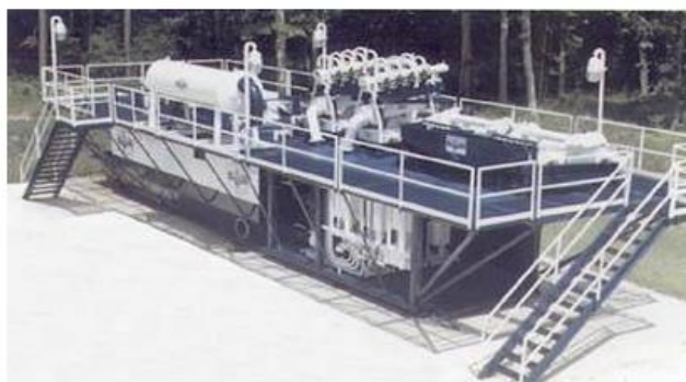
Bazen za pročišćavanje i otplinjavanje isplake
