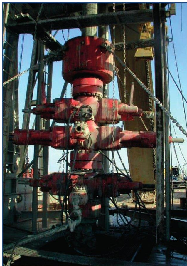
Slika 1.13 Primjer tipičnog preventerskog sklopa (BOP) (Potter, 2018)
