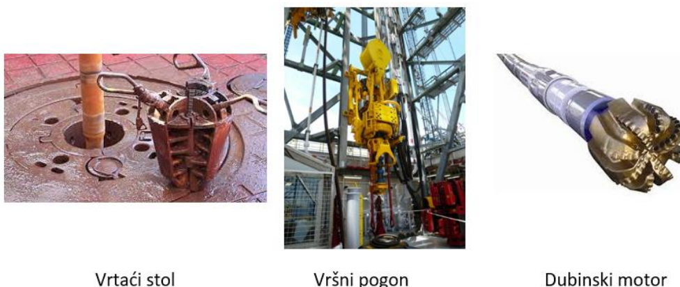
Slika 1.9 Primjeri vrtaćeg stola, vršnog pogona i dubinskog motora (Gaurina, 2022.)
