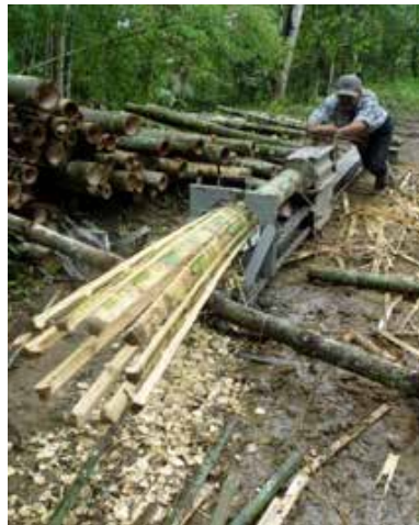
Figura 19: Obtención de latillas con máquina operada manualmente
