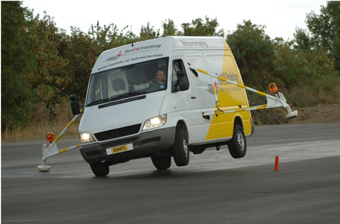
Abbildung 7.5: Kipp-Fahrzeug des ÖAMTC [12]
