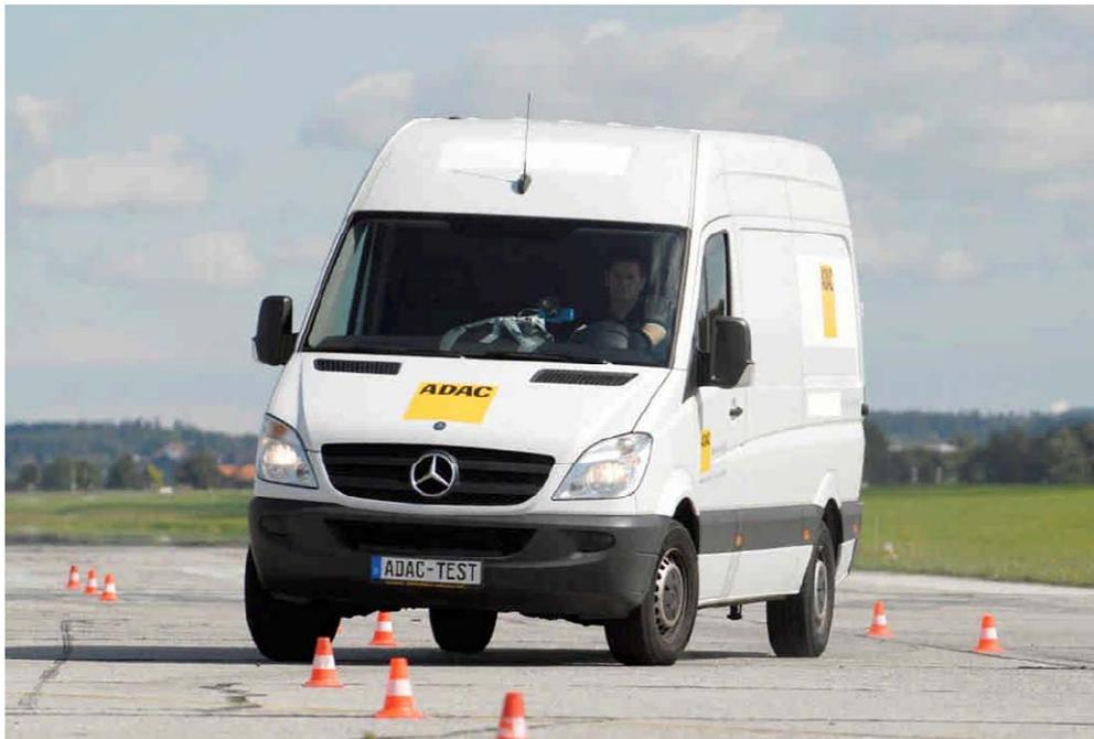
Abbildung 5.4: Doppelter Spurwechsel mit ESP [14]
