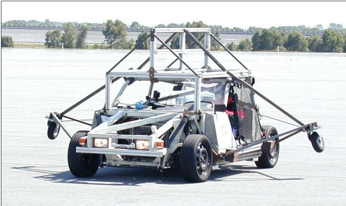
Abbildung 7.2: Fahrdynamikauto der DaimlerChrysler AG [10]
