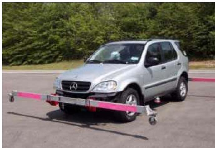
Abbildung 7.1: SUV der NHTSA mit Kippvorrichtung [10]
