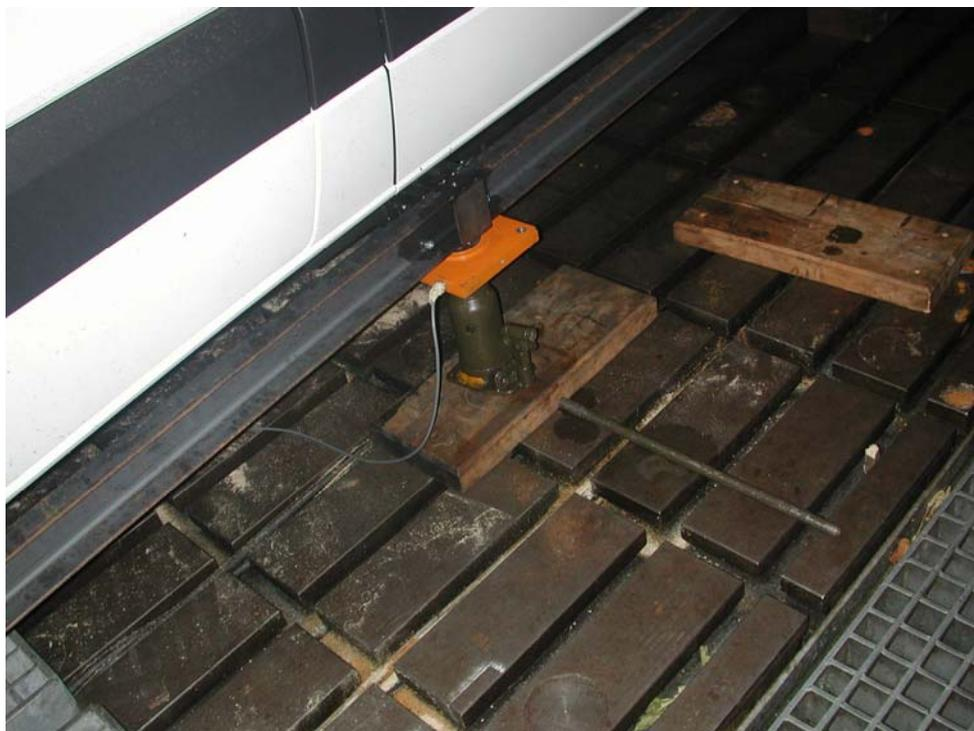
Abbildung 12.2a: Versuchsaufbau Wagenheber links (Druckseite)
