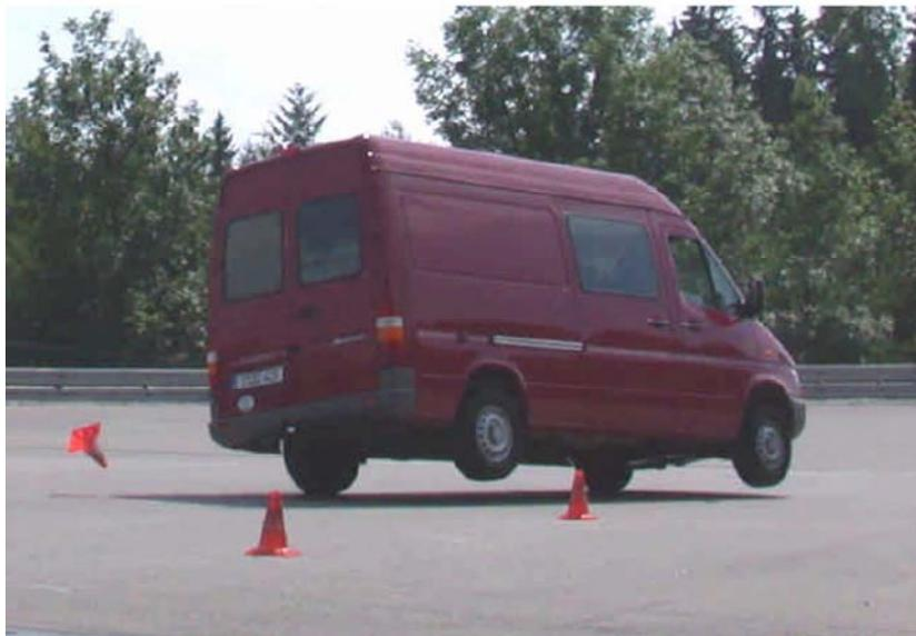
Abbildung 4.2: Kippvorgang über das Kurvenäußere Vorderrad bei doppeltem Spurwechsel [14]
