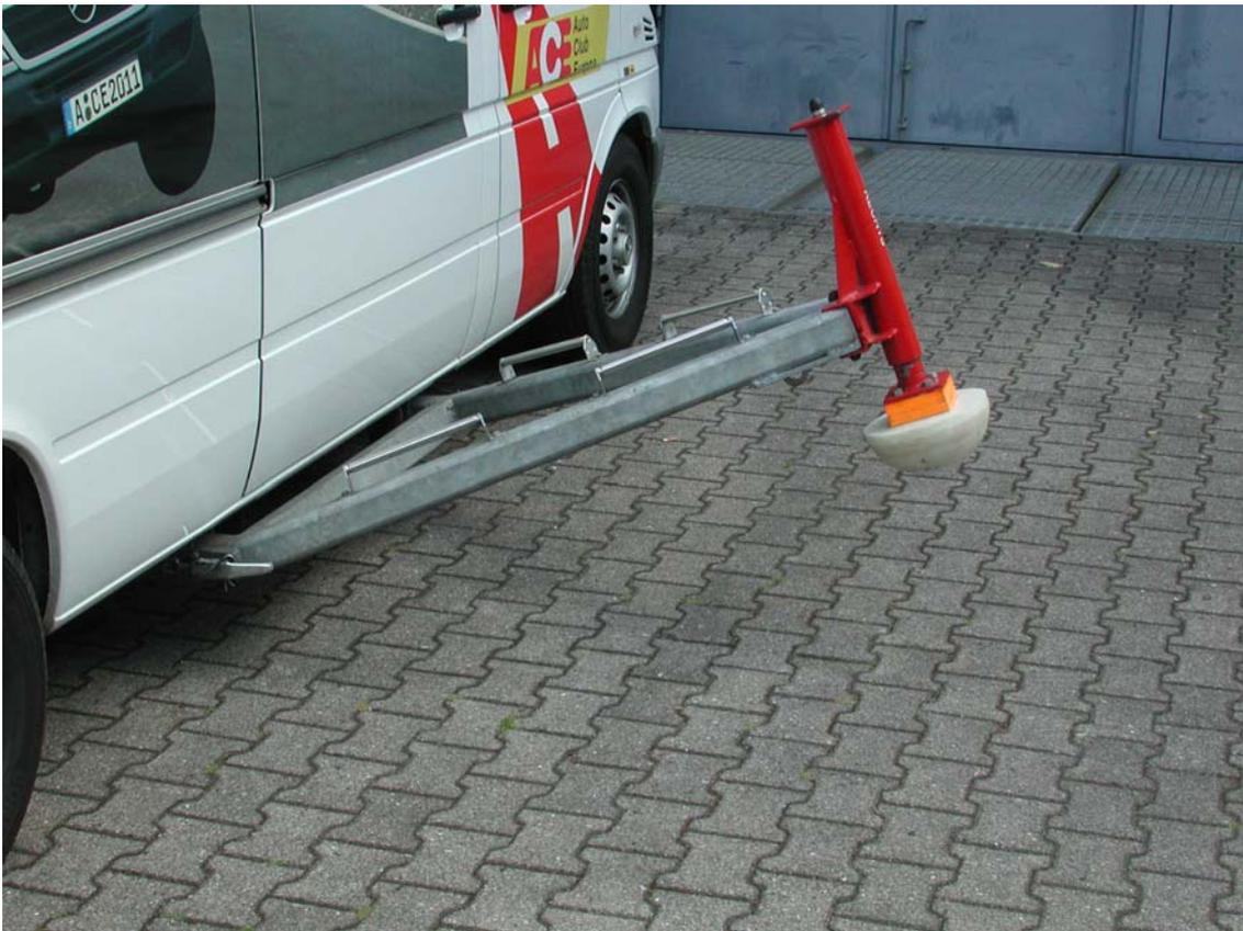
Abbildung 7.4: Stütze des "Kipp-Sprinter"
