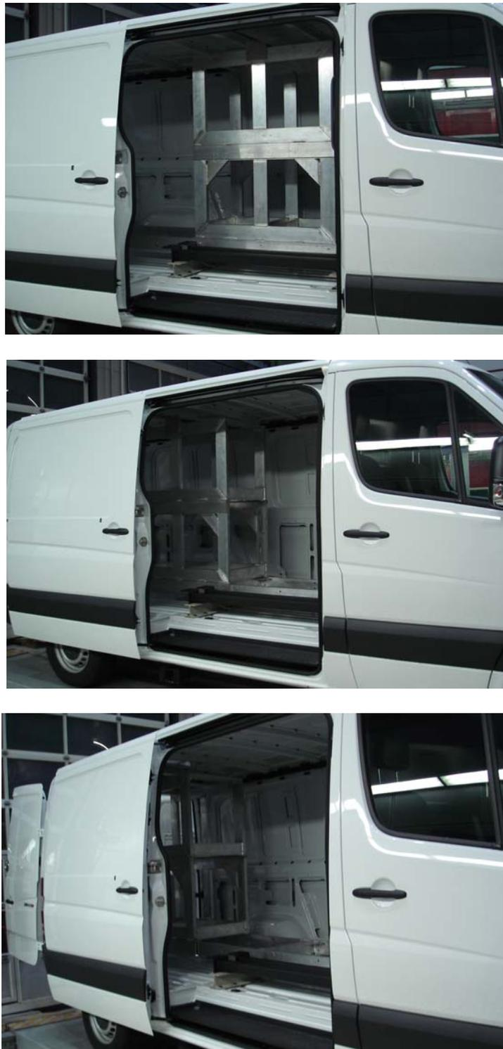
Abbildung 13.3: Beladungseinrichtung bei unterschiedlichen Positionen
