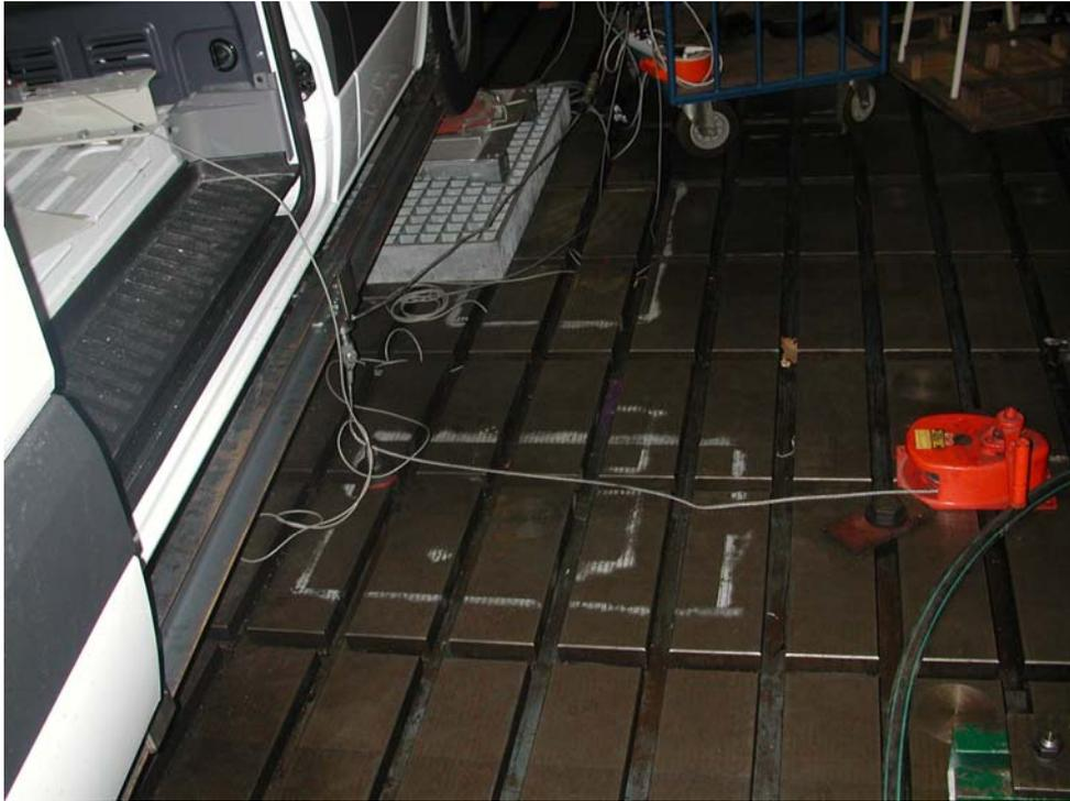
Abbildung 12.2b: Versuchsaufbau mit Rad auf dem Teller und Wagenheber rechts (Zugseite)
