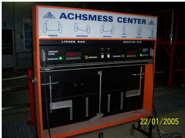
Abbildung 12.12: Achsvermessungsgerät, Hauptkonsole
