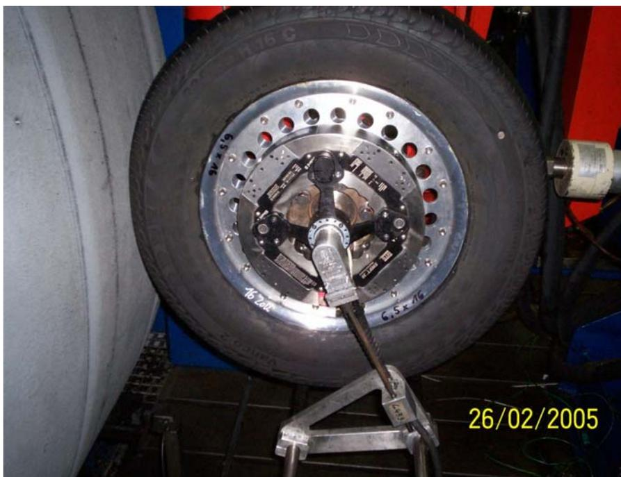
Abbildung 12.20: Continental Vanco 2 mit Messnabe MTS Swift 30 auf Reifenprüfstand
