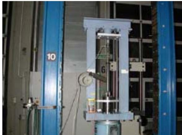
Abbildung 12.26: Dämpferprüfstand
