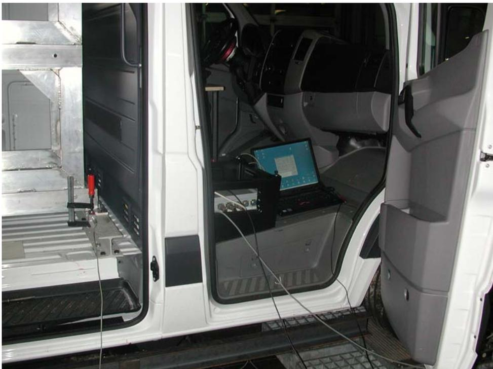
Abbildung 12.3: Datenerfassung bei der Gesamtwanksteifigkeitsmessung
