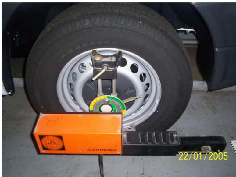
Abbildung 12.13: Achsvermessungsgerät, Messeinrichtung rechts
