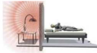
Für das elektrische Feld ist die Abschirmwirkung von Backstein und Betonwänden beachtlich gross.
