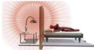
Die Holzwand hat keine Schirmwirkung auf das elektrische Feld.
