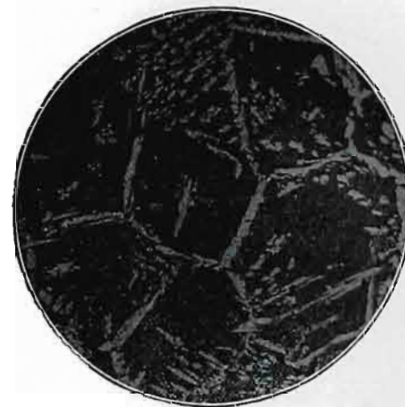
Abb. 13. Lineare Vergrößerung 180. Zusammenhängende, sekundär ausgeschiedene nadelige \alpha -Kristalle in \alpha - \beta -Messing, bei Zimmertemperatur noch plastisch. Geätzt rd. 5 min in warmer Schwefelsäure 1:1
