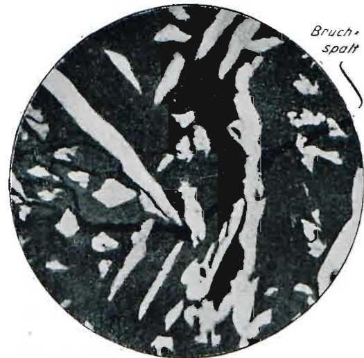
Abb. 19. Lineare Vergrößerung 450. Intragranularer \beta -Kaltbruch in \alpha - \beta -Messing. Geätzt rd. 5 min in warmer Schwefelsäure 1:1.
