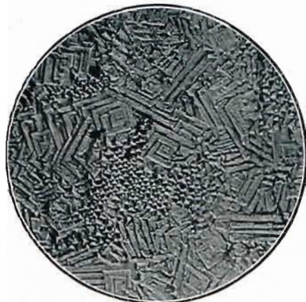
Abb. 5. Lineare Vergrößerung 60. Wachstumskristalle von Wismut; Erstarrungsfläche eines auf kalter Metallplatte aufgefangenen Metalltropfens. Ungeätzt.
