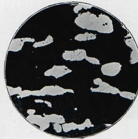
Abb. 14. Lineare Vergrößerung 180. Unzusammenhängende, eingefomte rundliche \alpha -Kristalle in \alpha - \beta -Messing, bei Zimmertemperatur glasspröde. Geätzt rd. 5 min in warmer Schwefelsäure 1:1.
