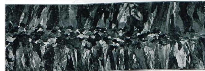
Abb. 24. \frac{4}{5} natürl. Größe. Beim Kaltrecken geknetete und verbogene Gußkristalle aus Aluminiumbronze; jedes Kornindividuum als Ganzes erhalten. Geätzt rd. 30 min in 10prozentiger Ammoniumpersulfatlösung.
