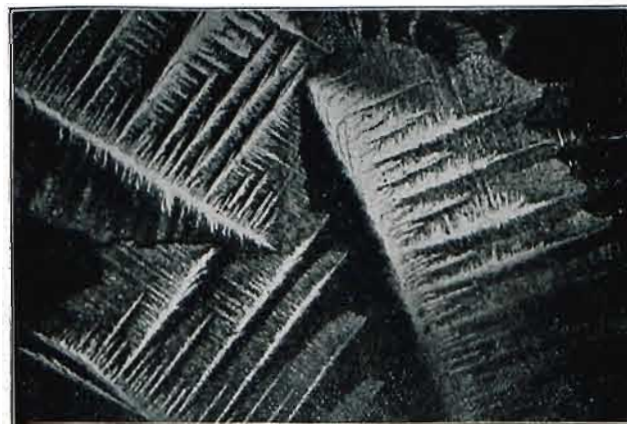
Abb. 6. Lineare Vergrößerung 60. Wachstumskristalle von Aluminium; Erstarrungsfläche eines auf kalter Metallplatte aufgefangenen Metalltropfens. Ungeätzt.
