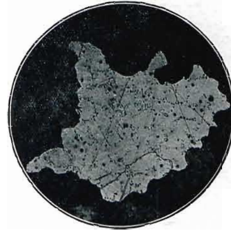
Abb. 7. Lineare Vergrößerung 40. Allotriomorphe Haufwerkskristalle von Kupfer in uneingefomtem Guß. Aetzipoliert mit ammoniakgetränktem Wattausch.
