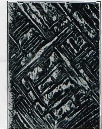
Abb. 38 und 39. Lineare Vergrößerung 60. Ätzgefüge von Rohzinkkristallen. Geätzt rd. 30 min in konzentrierter Chromsäurelösung.
