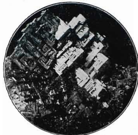
Abb. 4. Lineare Vergrößerung 1. Wachstumskristalle von Wismut, durch unterbrochene Kristallisation erhalten. Ungeätzt.
