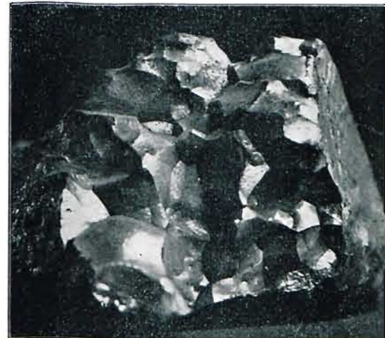
Abb. 17. Lineare Vergrößerung 1,8. Intergranularer Warmbruch in Weichblei. Ungeätzt.
