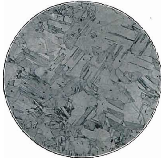
Abb. 46. Lineare Vergrößerung 180. Auf der polierten ungeätzten Schlißfläche eines \alpha -Messingkristalles nach dem Kaltrecken sichtbare Kehrlinien.
