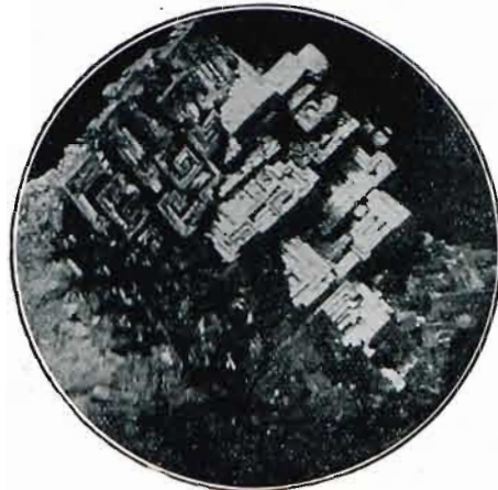
Abb. 4. Lineare Vergrößerung 1. Wachstumskristalle von Wismut, durch unterbrochene Kristallisation erhalten. Ungeätzt.
