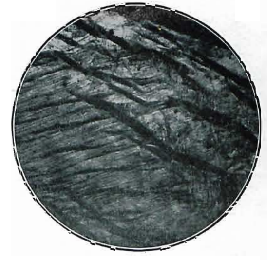
Abb. 49. Lineare Vergrößerung 180. Nach dem Aetzen im metallischen Querschnitt sichtbare banalisierte Kehr- und Gleitlinien auf einem stark gereckten Aluminiumbronze- \alpha -Kristall. Aetzpoliert mit ammoniakgetränktem Wattebausch.
