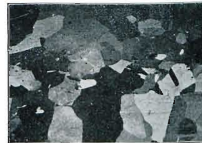
Abb. 21. \frac{4}{5} natürl. Größe. Eingeformtes \alpha -Messing im kristallinischen Gleichgewicht. Geätzt rd. 30 min in 10prozentiger Ammoniumpersulfatlösung.
