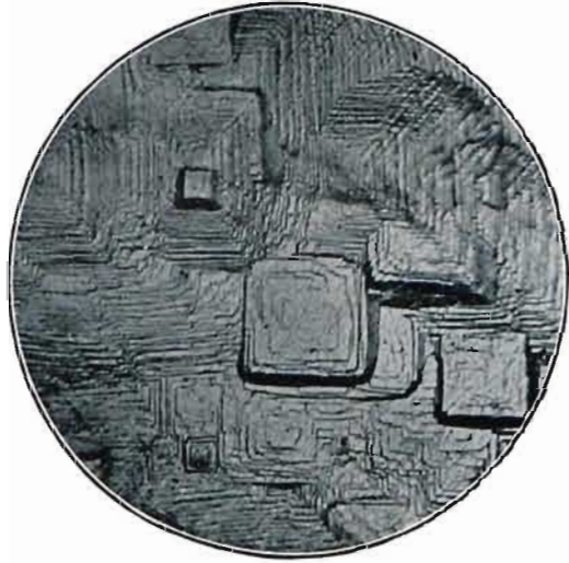
Abb. 42. Lineare Vergrößerung 180. Kupferkristall mit Aetzfiguren. Geätzt rd. 2 Stunden in 10prozentiger Ammoniumpersulfatlösung.
