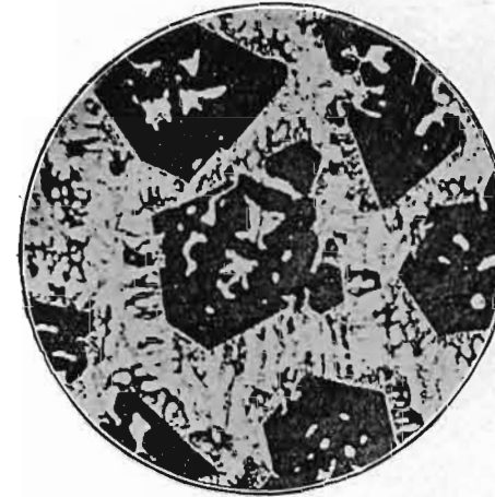
Abb. 9. Lineare Vergrößerung 180. Idiomorphe Kristalle in der mehrphasigen Legierung aus 50 vH Zn + 40 vH Sn + 10 vH Mg. Geätzt durch Verdunsten eines Tropfens Salzsäure auf der Schliiffäche.
