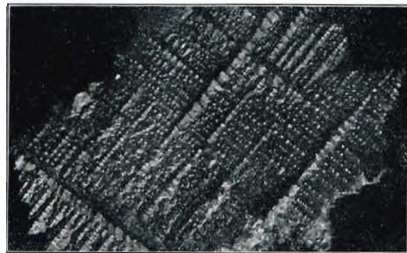
Abb. 2. Lineare Vergrößerung 2,4. Wachstumskristalle von Blei, die als erstarrte Kruste von der noch flüssigen Schmelze abgehoben wurden. Ungeätzt.
