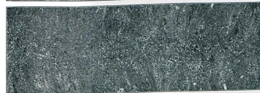
Abb. 25. \frac{4}{5} natürl. Größe. Zerfall und Neuordnung der Aluminiumbronzekristalle beim Aus- glühen nach dem Kaltrecken. Geätzt rd. 30 min in 10prozentiger Ammoniumpersulfatlösung.
