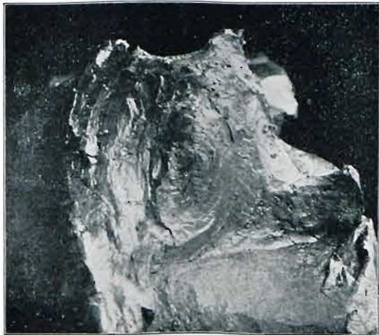
Abb. 16. Lineare Vergrößerung 1,8. Intragranularer Kaltbruch im Weichblei. Ungeätzt.
