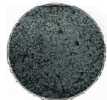
Abb. 51. Lineare Vergrößerung 400. \alpha -Messing nach äußerst kräftiger Kaltreckung; Korninneres bis zur Homöotropie verlagert. Geätzt rd. 30 min in 10prozentiger Ammoniumpersulfatlösung.
