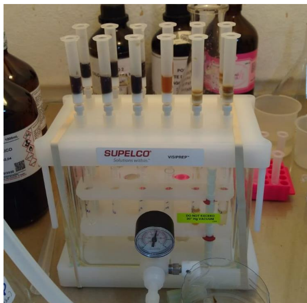
Figura 10. Imagem da SPE realizada na “Extração 4”. Etapa de adição da amostra nos cartuchos de SPE acoplados ao manifold .
