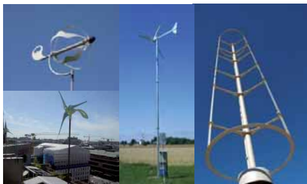
Exempel på små vindkraftverk. Överst till vänster Eneq ball 500 W, 1,1 m diam. Nedan Airdolphin/Egen El 1000 W, 1,8 m diam. Mitten Winddon 2 kW, 3,2 m diam 9 m mast. Höger Windspire 1,2 kW, 2,4 m diam, 9 m hög.
