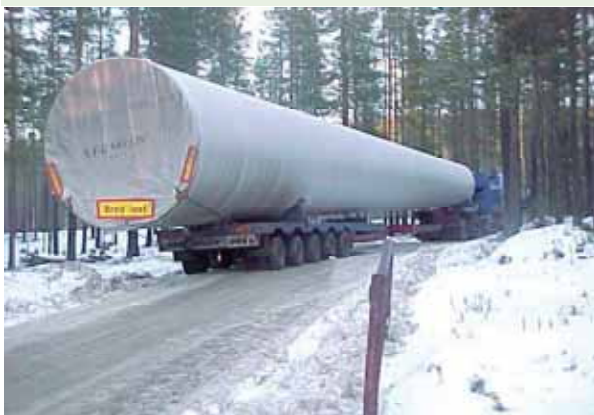
Tornen kan delas upp i kortare delar. Svårare är det med rotorbladen som kan vara 45 m långa för ett 3 MW verk.
