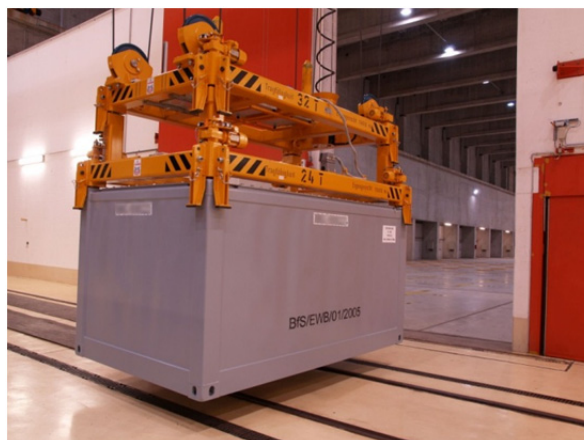
Abb. 10: Spreader für Container Typ III/IV (fest eingesichert) mit zusätzlichem Spreader für Container Typ V
