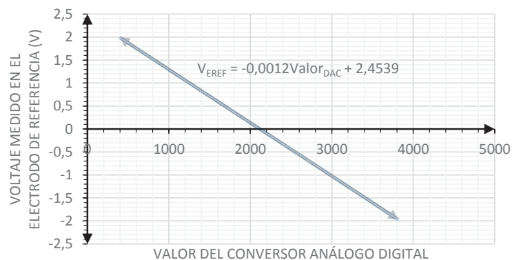
Figura 2.27. Relación entre el voltaje medido en el electrodo de referencia y el valor del convertidor análogo digital.
