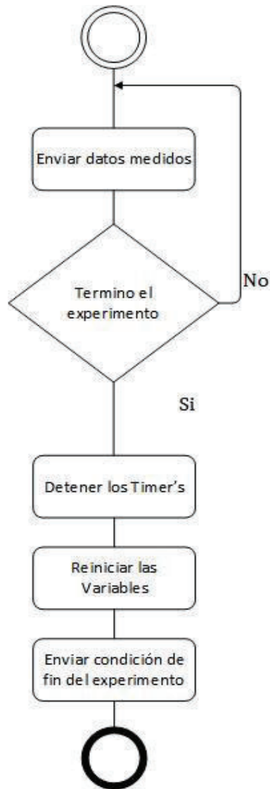
Figura 3.6. Diagrama de flujo para el envío de datos medidos a la HMI.
