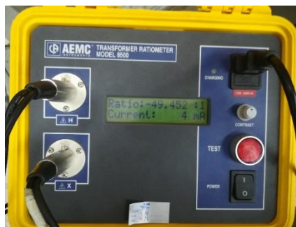
Figura 2.7. Equipo de medición de relación de transformación AEMC 8500. Laboratorio de Alto Voltaje EPN.
