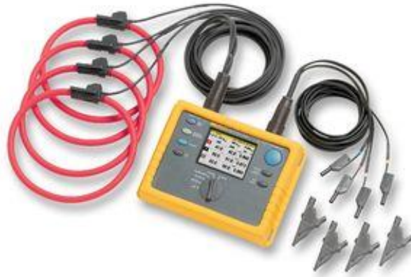
Figura 2.9. Analizador Trifásico Fluke 1735. Laboratorio de Alto Voltaje EPN.
