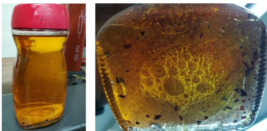
Figura 2.12. Muestra de aceite del transformador bajo prueba.
