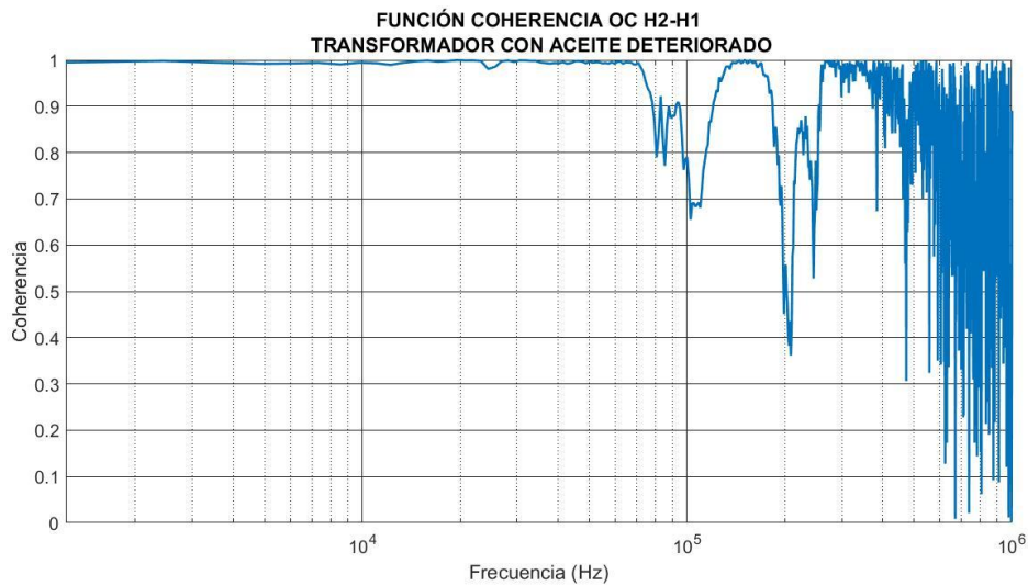
Figura 3.6. Coherencia. Tipo de prueba: OC H2-H1. Transformador con aceite deteriorado.
