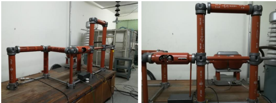
Figura 2.20 Generador de impulsos modular. Laboratorio de Alto Voltaje EPN.
