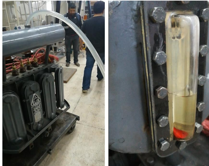
Figura 2.17. Llenado y verificación de nivel de aceite.
