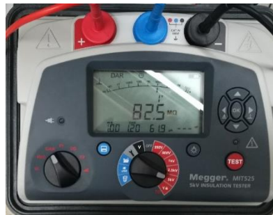
Figura 2.3. Equipo de medición de resistencia de aislamiento Megger MIT525. Laboratorio de Alto Voltaje EPN.
