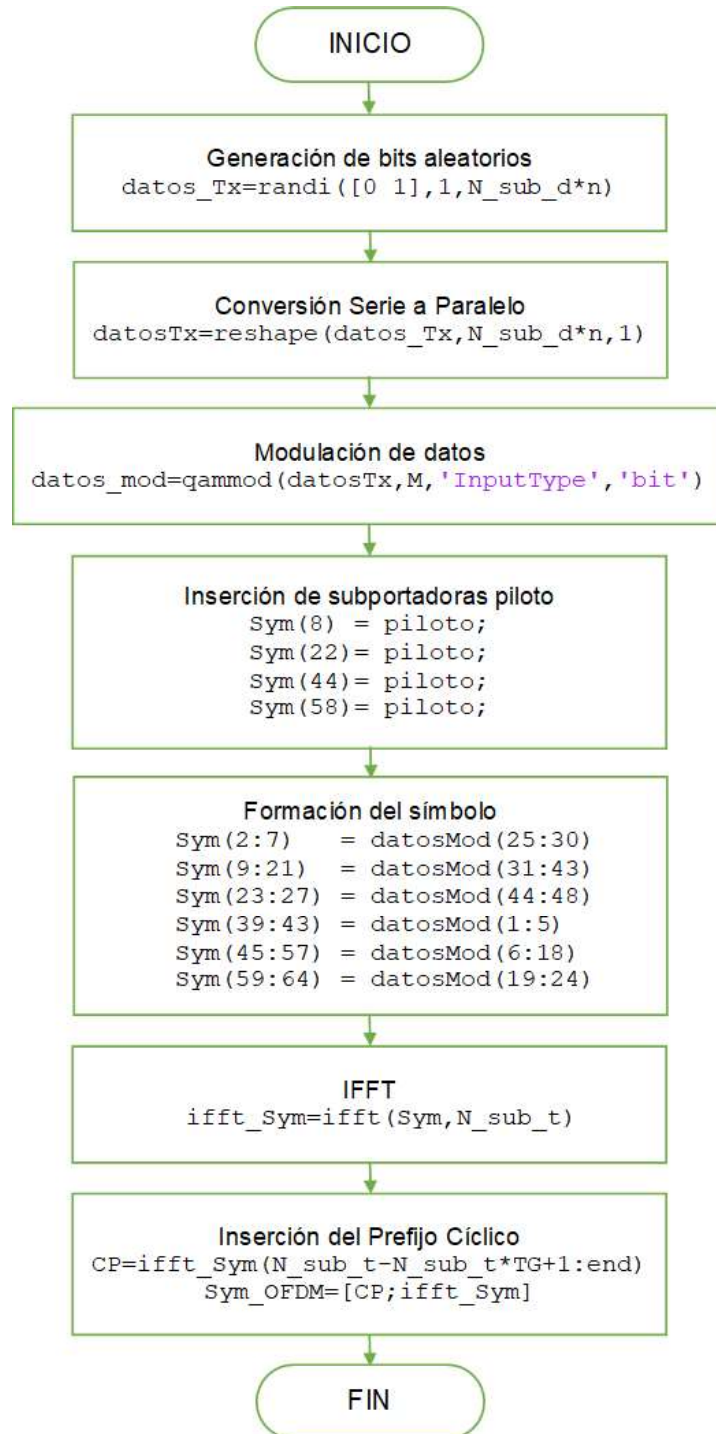
Figura 2.2. Diagrama de flujo del transmisor OFDM sin diversidad.
