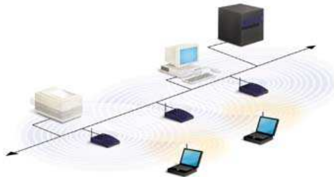
Fig. 2.2. Conexión de dispositivos Inalámbricos a redes alámbricas
