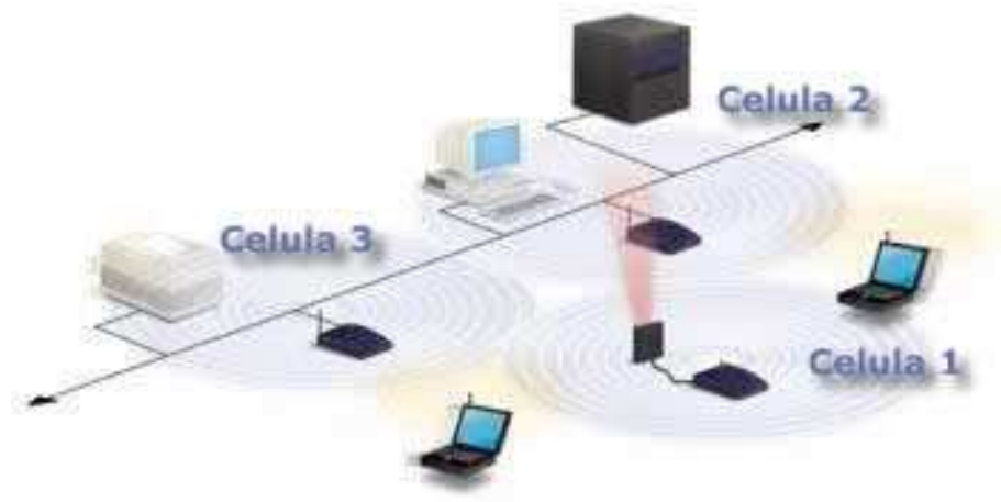
Fig. 2.10 Roaming con 3 células
