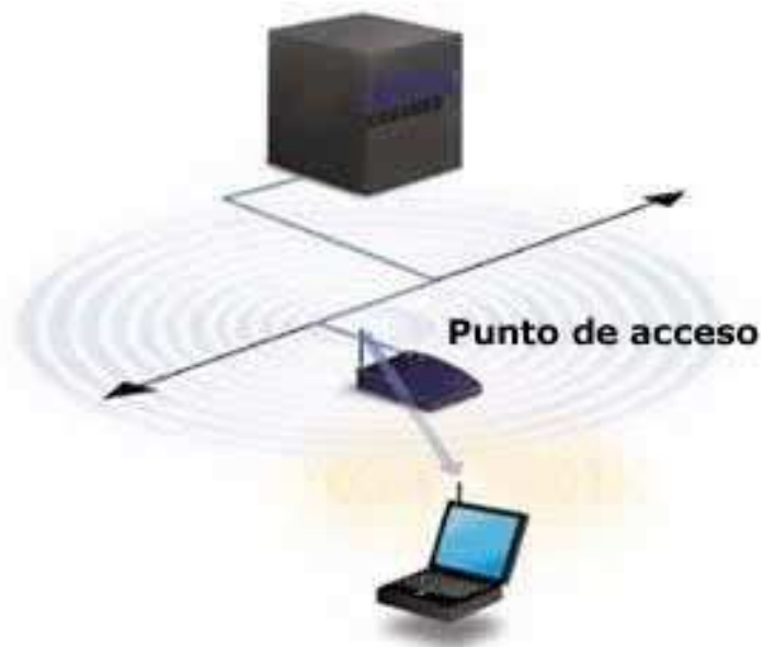
Fig. 2.8 WLAN en modo Infraestructura
