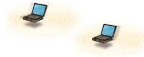
Fig. 2.7 Disposición en modo ad-hoc
