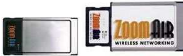
Fig. 1.11. Tarjeta PC Card compatible PCMCIA 3.3v y 5v.
