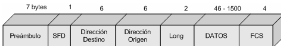
Figura 1.7 Formato de trama para IEEE 802.3. [4]
