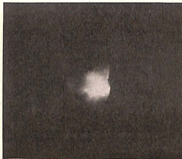
Photographie n° 6. — 5 cartouches de dynamite-gomme dans un canon de pierre, sans bourrage — Détonateur au fond.
