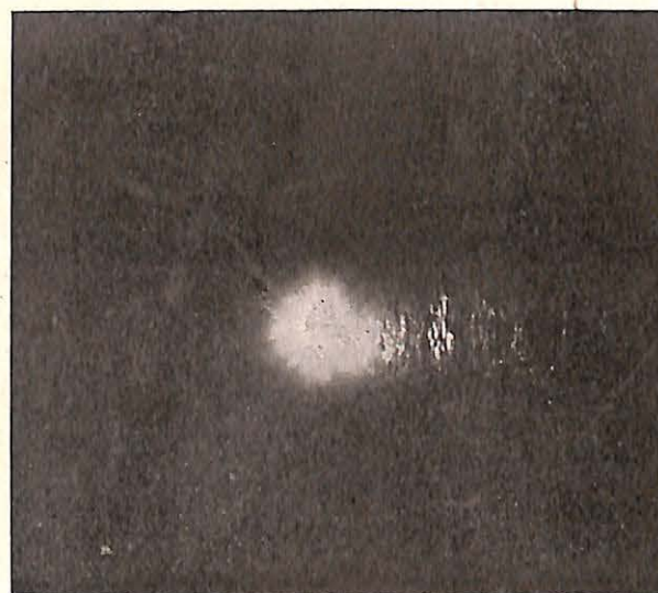
Photographie n° 7. — 5 cartouches de dynamite-gomme dans un canon de pierre, sans bourrage. — Détonateur au fond.
