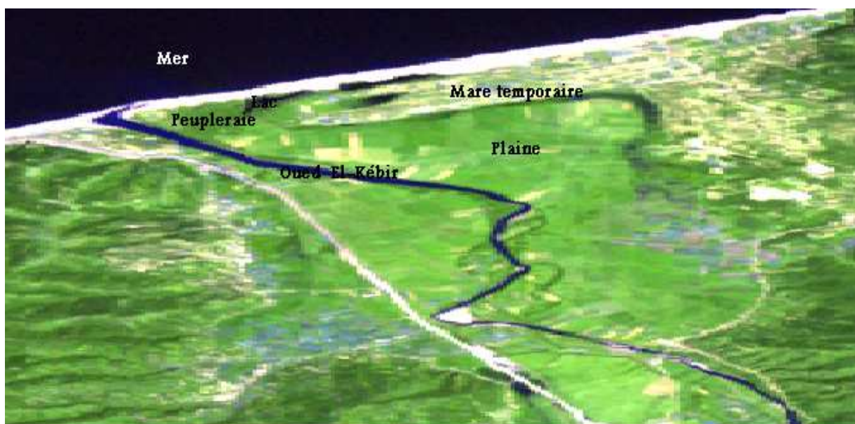
Figure25. Composition colorée 7-5-3, montre terrains inondés en bleu-noir et noir (image Landsat ETM, du 11/04/2010).
