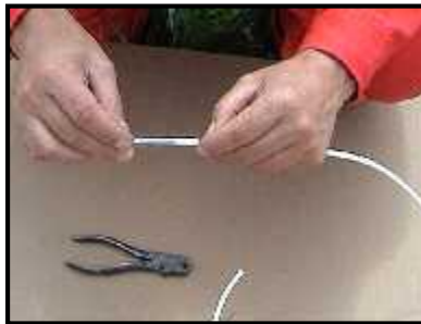
Figura 5-7 Cebado de la Cápsula. Fuente: INDUMIL.
