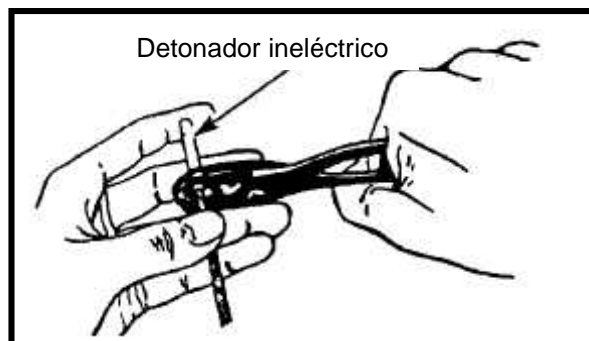
Figura 5-8 Engarce de la Mecha. Fuente: Manual FM 5-250.
