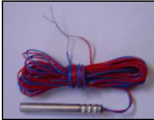
Figura 5-10 Detonador Eléctrico. Fuente: Grupo Marte ESING.
