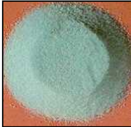
Figura 2-2 PENT explosivo rompiente. Fuente: ATF..
