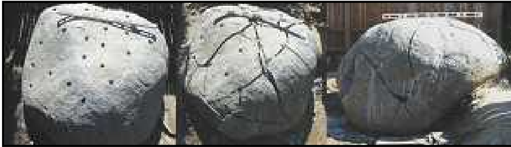
Figura 2-34 Efectos de Corte. Fuente: Cemento Demoledor.com.
