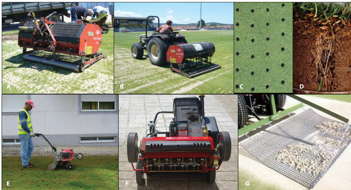
Equipamentos para arejamento: A – arejador por furação; B – operação de arejamento; C – aspecto da superfície após furação; D – buraco de furação no solo; E – arejador de facas/escarificação; F – equipamento de arejamento automotriz; G – nivelamento após distribuição de areia.
