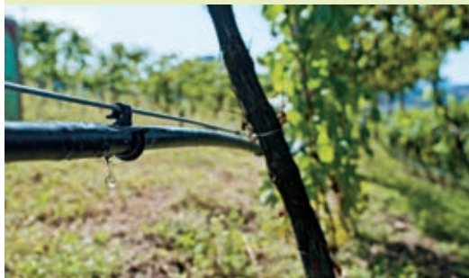
Spart Wasser und Energie: Tropfbewässerungsanlage auf einem Weinberg nahe Faedo.
