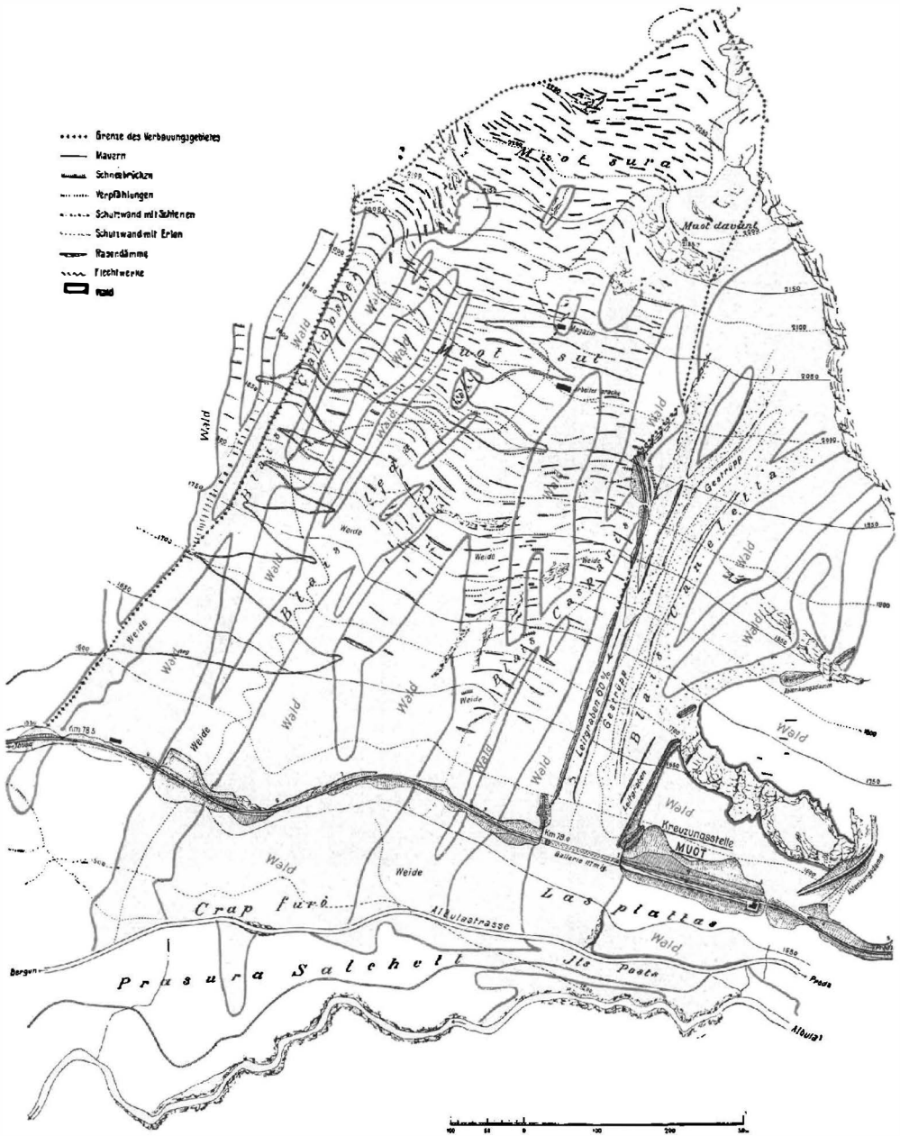
Abb. 79. Lawinenschutzbauten (Lawinengalerie und Schneefänge) an der Albulabahn bei Kreuzungsstelle Muot
