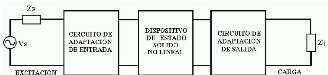
Figura 3.1: Circuito equivalente de un componente no lineal de dos puertos
