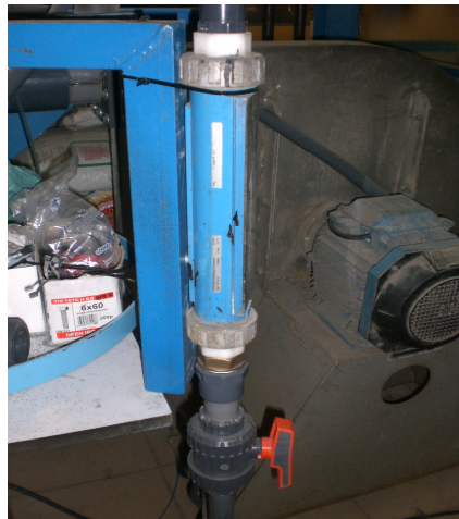
Foto 14. Rotámetro de aire comprimido con válvula de bola para regulación
