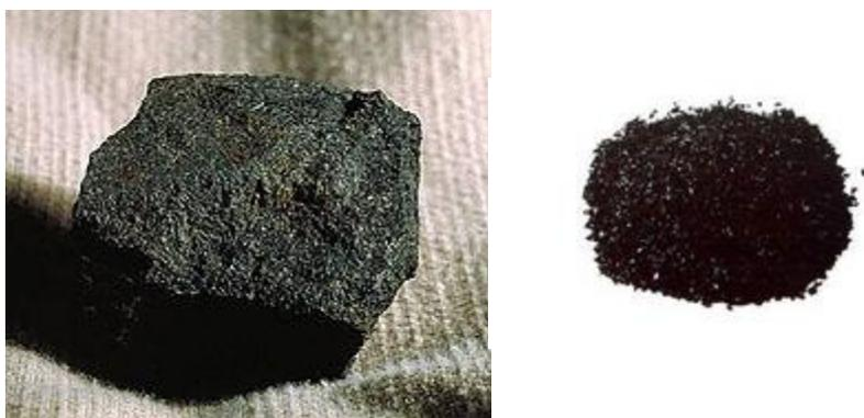
Figura AVII-6: Hulla bituminosa y char generado a partir de ella
