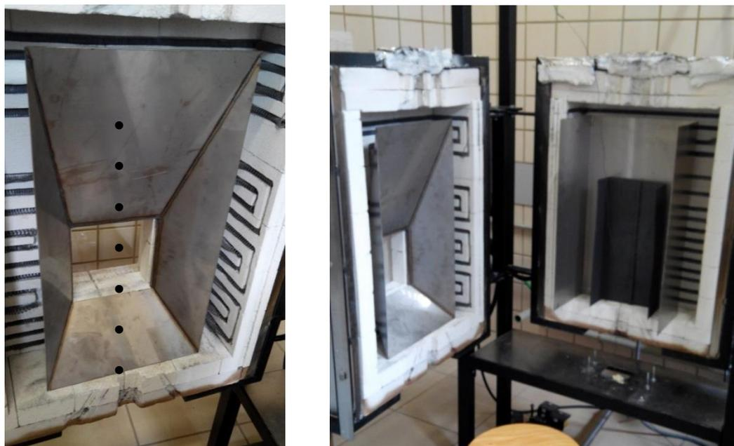
Figura 3-2: Chapas aislantes de radiación interna del horno de la instalación de laboratorio
