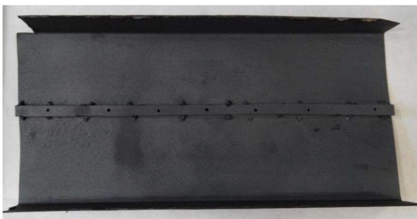
Figura 3-12: Cuerpo negro usado en los ensayos de calibración/validación
