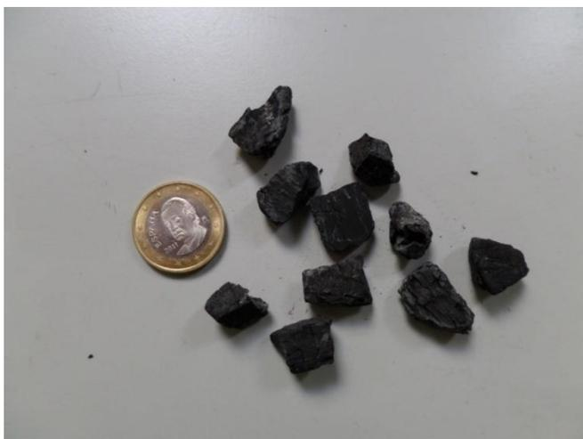
Figura AVII-2: Char generado a partir de hulla subbituminosa
