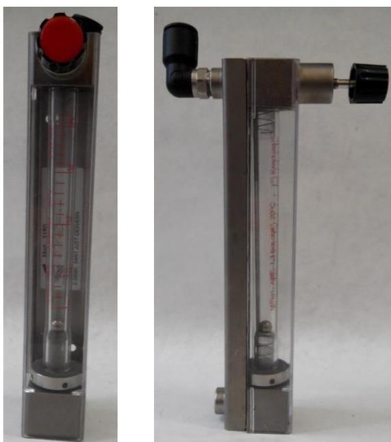
Figura 3-9: Rotámetro de la instalación de laboratorio
