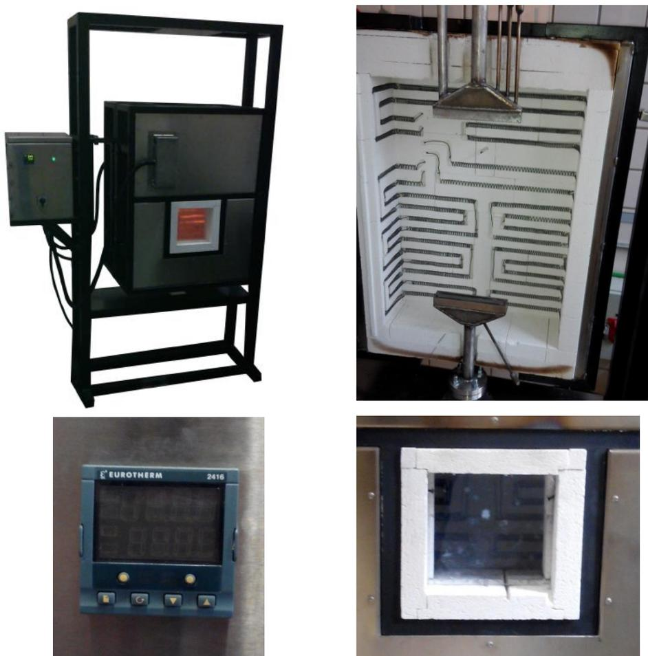
Figura 3-1: Distintas partes del horno eléctrico de la instalación de laboratorio
