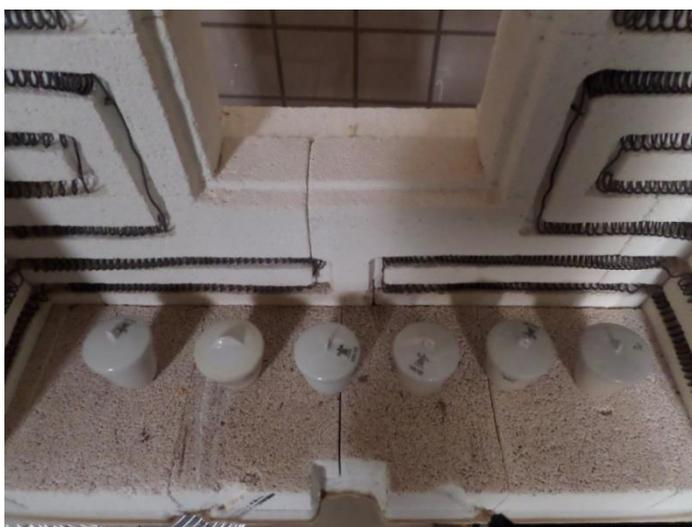
Figura AVII-1: Disposición de los crisoles en una de las puertas del horno eléctrico
